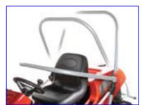
Der umklappbare Überrollbügel garantiert optimalen Schutz und absolute Sicherheit. Mit Scharnieren lässt sich der Bügel für den Transport mühelos und schnell (werkzeuglos) umklappen.
