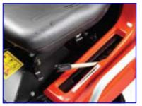
Zentrale Schnitthöhenverstellung über Hebel, bequem, links vom Sitz aus einzustellen.
