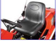
Ergonomischer, gut gepolsterter Sitz, auch geeignet bei längeren Arbeitseinsätzen. Durch einen Hebel kann der Abstand zum Lenkrad eingestellt werden.
